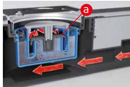
Kod nadtlaka u kanalizaciji: ventilni disk naliježe na sjedište ventila tako da mirisi ne mogu ući u prostoriju. Dodatna prednost je da sifonski umetak sprječava povrat vode iz kanalizacije kroz sifon.
